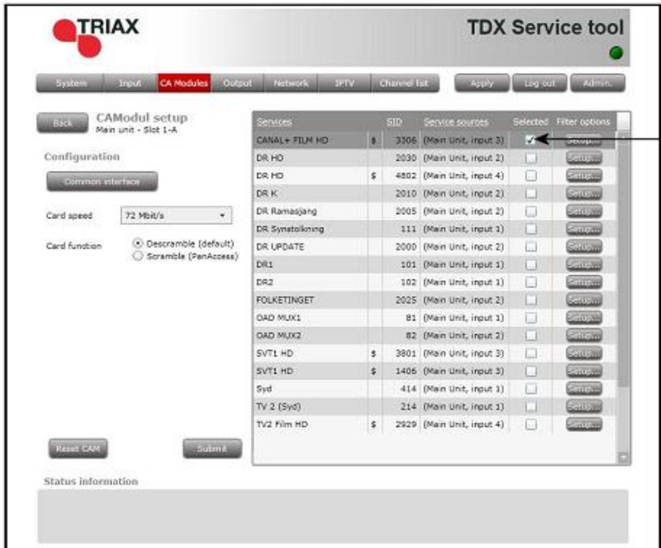
В этом же меню настройки можно выбрать скорость работы СА Модуля – 50 или 72 Мбит/с и его функцию - скрембирование (PanAccess) или дескрембирование.
