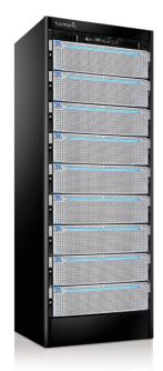
Система Omneon MediaGrid от компании Harmonic представляет собой легко масштабируемую систему хранения контента с совместным доступом, на базе Ethernet, которая выполняет активную обработку цифровых медиаданных, обладает высокой производительностью SAN-сетей и простотой хранилищ NAS.
