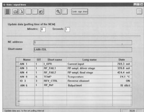
**NMS 86** (Network Management System – система сетевого менеджмента) предназначена для контроля и управления широкополосными CATV сетями и включает мощный интерфейс сетевого менеджмента, обеспечивая быструю связь между сетевыми компонентами и имеет хорошо организованный пользовательский интерфейс. NMS способна контролировать и управлять практически неограниченным числом сетевых элементов и не зависит от вида используемой топологии CATV сети.
