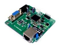
Транспондер (приёмо – передатчик) сетевого менеджмента – это устройство, предназначенное для сбора и передачи информации о параметрах контролируемого устройства и приёма команд управления им. Транспондер для оптического приёмника ОУК-800AGC-IP представляет собой компактное одноплатовое изделие, устанавливаемое в корпус приёмника и сопрягающееся с его элементами посредством штатного шлейфа.
